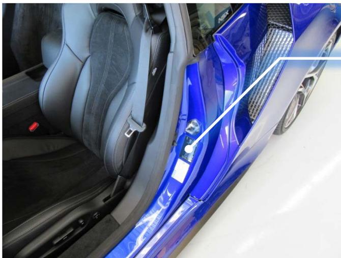
Imprimé sur l'étiquette du NIV sur l'ouverture de la portière du conducteur
