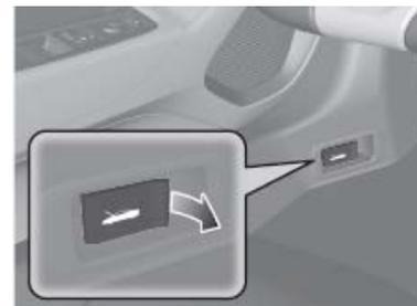
2. Repérez la détente d'ouverture du capot, poussez la détente et soulevez le capot.
