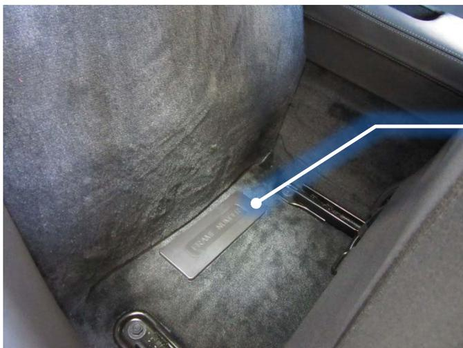
Estampé au plancher, derrière le siège du passager, sous le couvercle de plastique portant la mention **FRAME NUMBER**.
